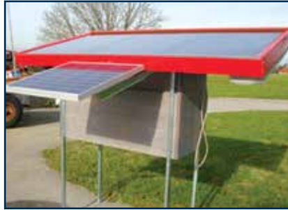
Uscător combinat: instalație electrică + baterii fotovoltaice
